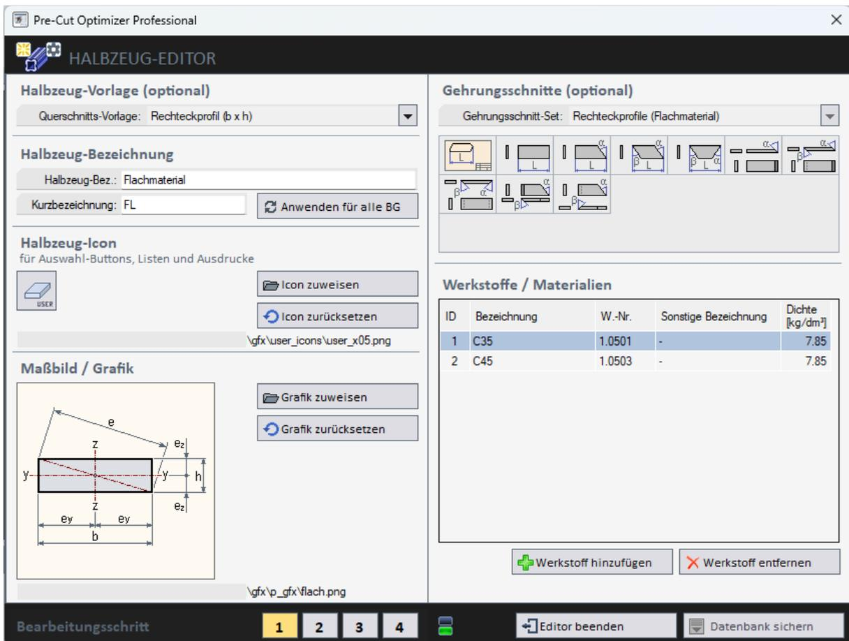
Bild 3-2: Halbzeug-Editor – Bearbeitungsschritt 1
