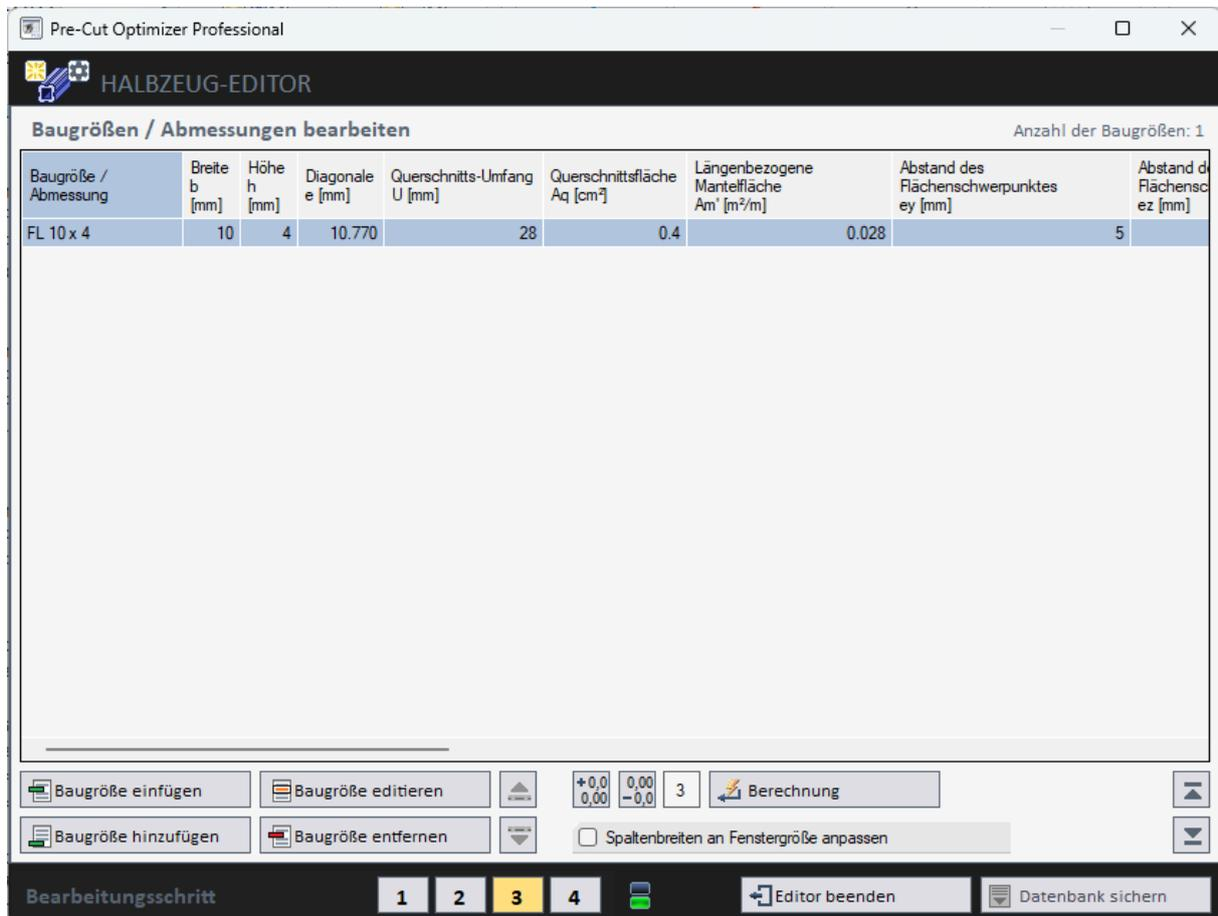
Bild 3-6: Halbzeug-Editor – Bearbeitungsschritt 3
