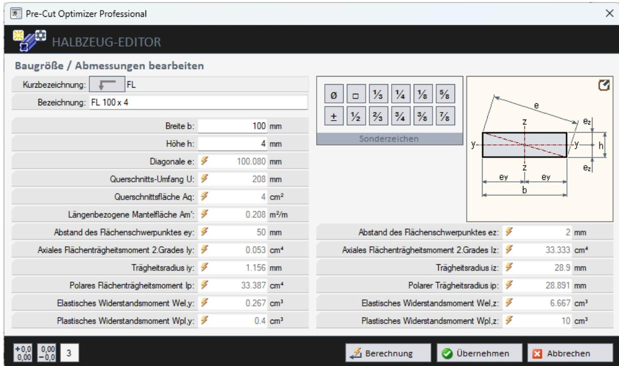
Bild 3-7: Halbzeug-Editor – Bearbeitungsschritt 3 – Baugröße / Abmessung bearbeiten
