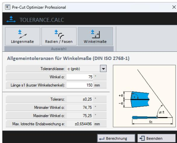
Bild 3-15: Tolerance.Calc – Winkelmaße
