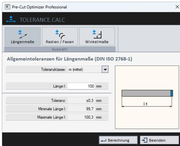
Bild 3-13: Tolerance.Calc – Längenmaße
